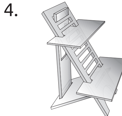
Когда консоль собрана, убедитесь в том, что все детали плотно прилегают друг к другу. Разборка консоли осуществляется в обратной последовательности. Сначала убираются полки (4, 5). Вертикальную распорку (3) рекомендуется вытаскивать через верхнюю прорезь панели (1). Для этого слегка надавите на верхний край панели (1) по направлению "вниз".
